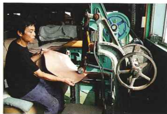
ガラスで革を磨くグレーズ加工。この作業により独特の光沢が生まれる
