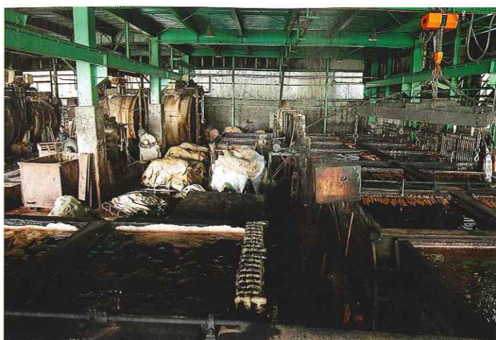
通常、なめしはドラムで行われるが、同社ではビット槽なめしを採用している。木製の槽を使っているため、タンニン液が地面に直接流れ込むことがなく、環境にやさしい
