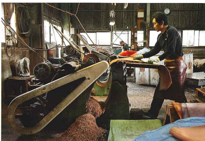
コードバンならではの「削り出し」作業。力加減を微妙に変えながら革を削りコードバンを露出させる。一人前になるまで3年は要する高度な技術だ
