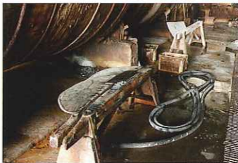
コードバンならではの「削り出し」作業。力加減を微妙に変えながら革を削りコードバンを露出させる。一人前になるまで3年は要する高度な技術だ
